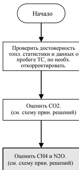
Рисунок 3.2.2 Схема принятия решений для выбросов CO<sub>2</sub> от сжигания топлива в дорожных транспортных средствах
