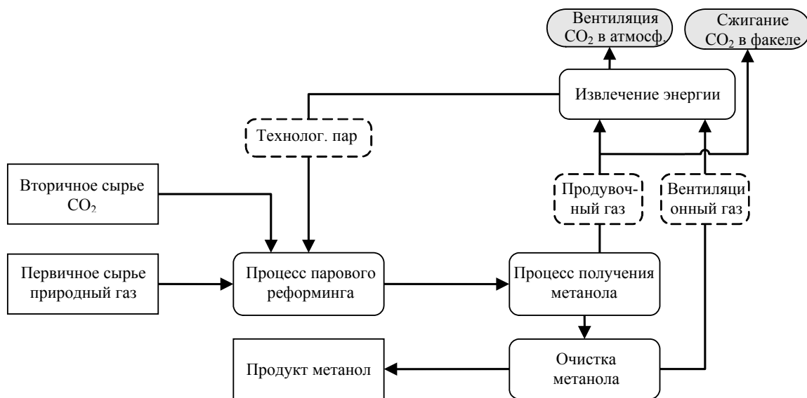
Рисунок 3.11 Диаграмма потоков сырьё-продукт для производства метанола
